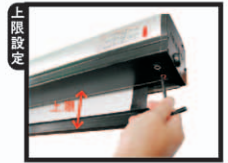
圖① 往A+方向旋轉時、布幕往上收起越多 往A-方向旋轉時、布幕往上收起越少
